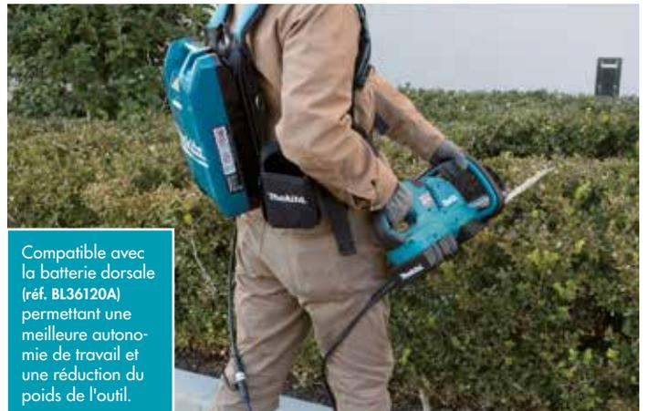
Compatible avec la batterie dorsale (réf. BL36120A) permettant une meilleure autonomie de travail et une réduction du poids de l'outil.
