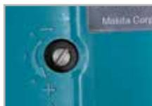
Lubrification automatique réglable de la chaîne
