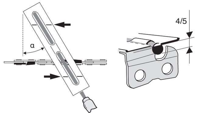
A la suite du nouvel affûtage, vérifier la hauteur du limiteur de profondeur avec la jauge de mesure pour chaîne. Voir accessoires pour le n° de commande.
