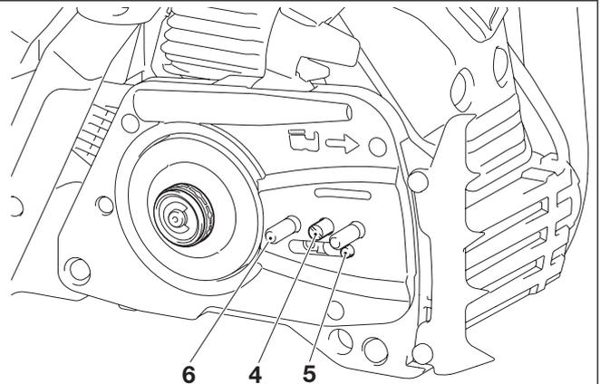
Poser le guide (7). S'assurer que le tenon (5) du tendeur de chaîne s'engrène dans le trou de la chaîne de sciage.
