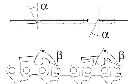
L'angle d'affûtage ( $\alpha$ ) doit être impérativement identique sur toutes les dents de rabotage.
