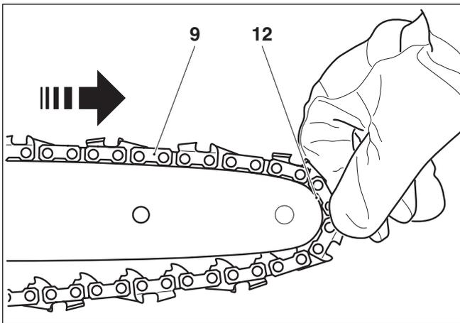
Guider la chaîne de sciage (9) autour de l'étoile de renvoi (12) du guide de la chaîne, en tirant légèrement la chaîne de sciage dans le sens de la flèche.
