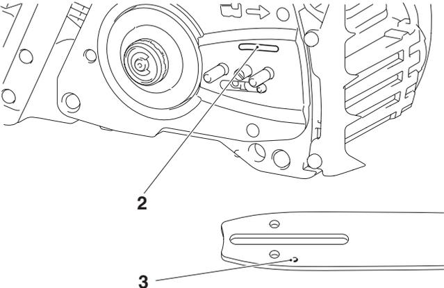
Pour que la pompe à huile fonctionne toujours parfaitement, la rainure de guidage d'huile sur le carter du vilebrequin (2), ainsi que les orifices d'entrée d'huile dans le guide de la chaîne (3) doivent régulièrement être nettoyés.
