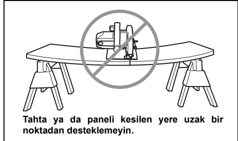
Geri tepmeyi önlemek için, tahta ya da paneli kesilen yerin yanından destekleyin.
