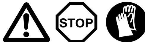
**ATTENTION:** Pour tous travaux effectués sur le guide de la chaîne de sciage, le moteur doit être impérativement arrêté et la fiche de bougie doit être enlevée (voir paragraphe pour le remplacement de la bougie) et le port de gants de protection est obligatoire!
